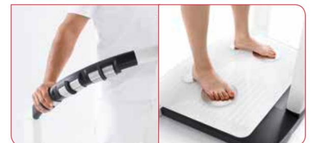
Les électrodes fixes intégrées évitent les erreurs de mesure et assurent une reproductibilité des résultats à tout moment.
