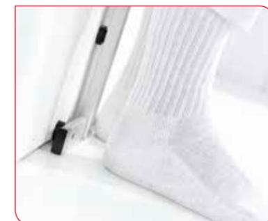
La butée de talon assure un positionnement exact et des résultats précis.
