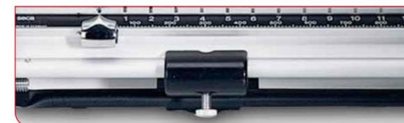
Le réglage du zéro garantit la détermination fiable du poids net, le poids d'un coussin ou d'une couche étant automatiquement déduit, comme une tare, du résultat de la pesée.
