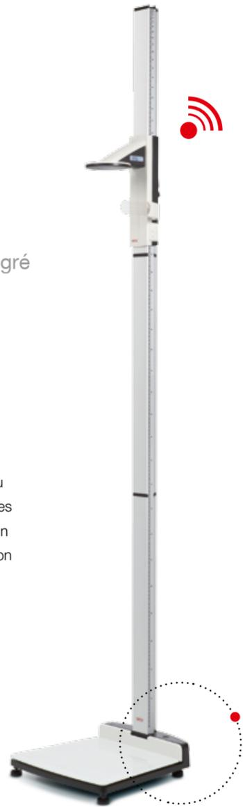
*La plateforme en verre stable à butée de talon intégrée garantit des résultats de mesure précis ainsi qu'une position sûre et ferme.*
