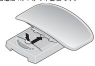
バッテリー収納部の蓋を開けて、付属 の乾電池をプラス極とマイナス極の 正しい方向に入れてください。
