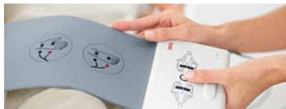
L'endroit où les électrodes doivent être placées est clairement indiqué sur l'unité de mesure. Chaque mesure ne débute qu'après une reconnaissance automatique des électrodes.
