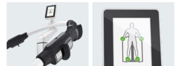
Les empreintes illuminées par LED sur la plateforme de pesée indiquent aux patients la position correcte des pieds. L'écran indique immédiatement si les électrodes sont en contact et que la mesure peut commencer.
