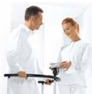
Omdat de handrail deel uitmaakt van het gewichtsgevoelige gebied, zijn de metingen 100% zeker, zelfs als de patiënt er op steunt.
