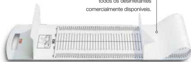
Uma escala de cada lado permite a medição da circunferência da cabeça e da simetria facial.
