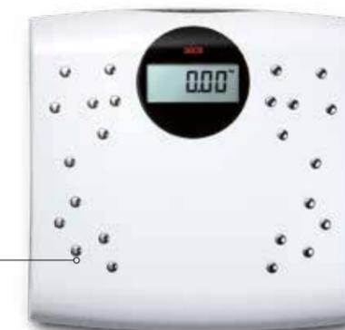
Os eletrodos de aço inoxidável cromado estão posicionados de modo a assegurar o contacto ininterrupto com a pele durante o processo de medição.
