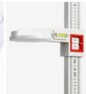
**Versão:** O nível integrado na peça para a cabeça do seca 213 I assegura que o estadiômetro sempre esteja posicionado corretamente em qualquer local.
