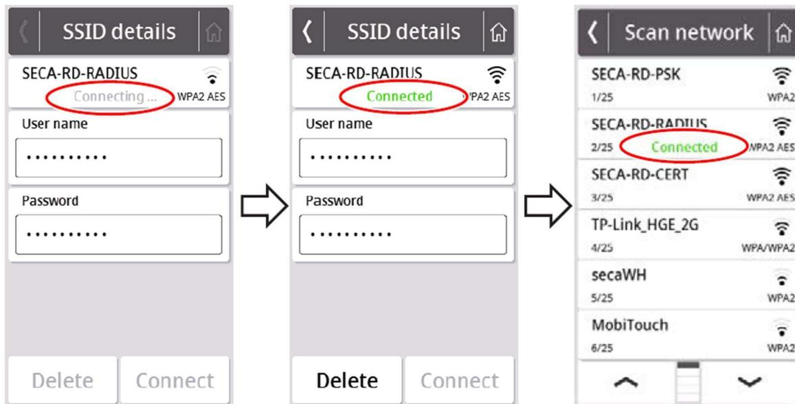
Das seca-Gerät stellt nun eine Verbindung zum ausgewählten WLAN-Netzwerk her. Sobald die Verbindung hergestellt ist, wird dies durch die Meldung "Verbunden" hinter dem ausgewählten Netzwerk angezeigt.
