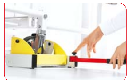
Le mécanisme à levier breveté permet de positionner les cellules de mesure sans effort.
