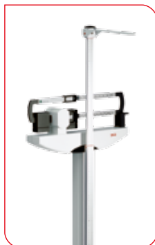
La toise seca 220 disponible en option permet de peser et de mesurer la taille en une seule opération commode.
